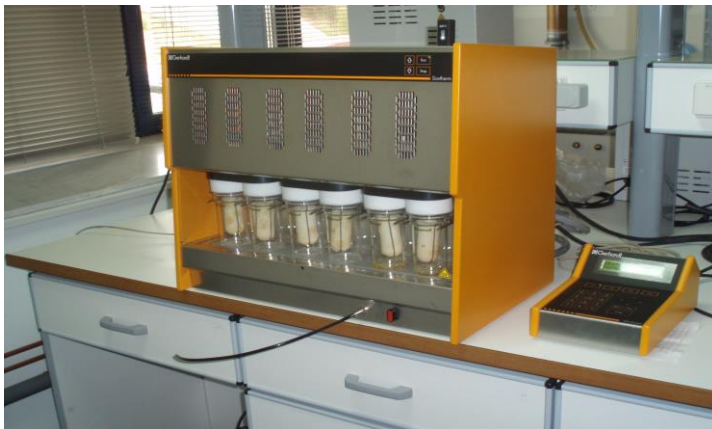
Εικόνα 8.2. Συσκευή εκχύλισης λίπους (Soxhlet) (Πηγή: Προσωπικό αρχείο).
