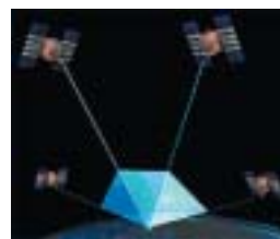
Εικ. 4. Καλή θέση των δορυφόρων του GPS. Αύξηση της ακριβείας του δέκτη GPS.
