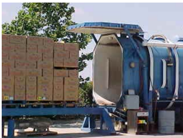
Σχήμα 6.3. Πρόψυξη με κενό.
