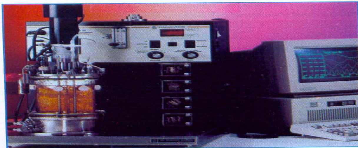
Εικόνα 4.15 (α) Σχηματική παράσταση συστήματος συνεχών καλλιεργειών. (β) Βιοαντιδραστήρας συνδεδεμένος με Η/Υ για τη συνεχή καταγραφή των αποτελεσμάτων.
