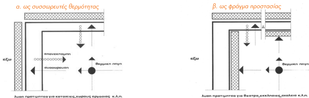
Σχήμα 2.3.1. Θερμοχωρητικότητα δομικών στοιχείων ανάλογα με τη θέση της θερμικής μόνωσης (εσωτερικά ή εξωτερικά)
