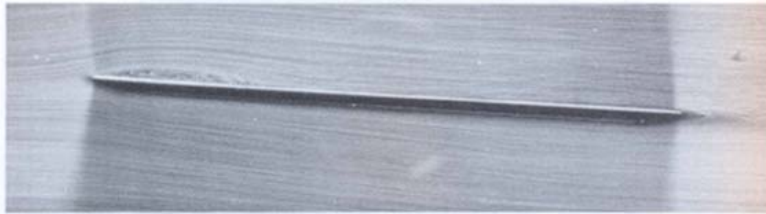
Σχήμα 10.7 Δημιουργία μικρής έκτασης ζώνης αποκόλλησης κοντά στην ανάντι ακμή της επίπεδης πλάκας για μικρές γωνίες πρόσπτωσης. (Van Dyke, No. 35).
