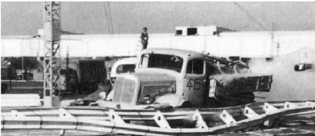
Ομοσπονδιακή Δημοκρατία Γερμανίας 1965: Ενισχυμένα αμφίπλευρα μεταλλικά στηθαία, πρόσκρουση φορτηγού 10 t με ταχύτητα 67 km/h και γωνία 20°
