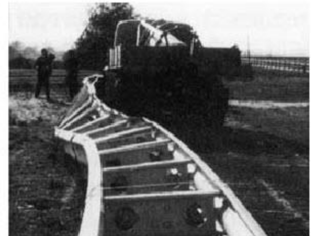
Ομοσπονδιακή Δημοκρατία Γερμανίας 1965: Ενισχυμένα αμφίπλευρα μεταλλικά στηθαία, πρόσκρουση φορτηγού 10 t με ταχύτητα 67 km/h και γωνία 20°
