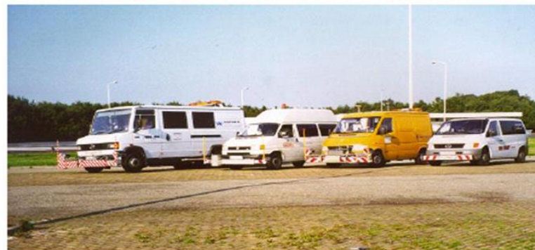
Φωτογραφία 4. Συστήματα μέτρησης ομαλότητας με ηλεκτρονικά μέσα
