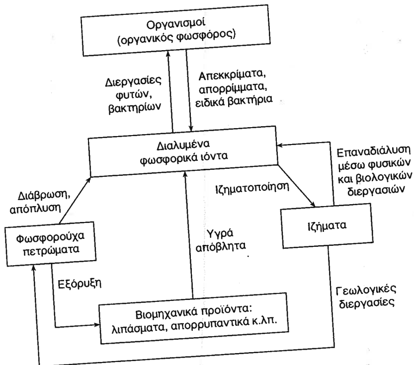
Σχήμα 4.6: Απλοποιημένο διάγραμμα του φυσικού και ανθρωπογενούς κύκλου του φωσφόρου.
