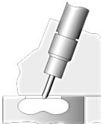
Θάλαμος καύσης κινητήρα απ' ευθείας έγχυσης
