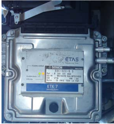
Εικόνα 1 Ο εγκέφαλος του κινητήρα DW12 τοποθετημένος στον DW10
