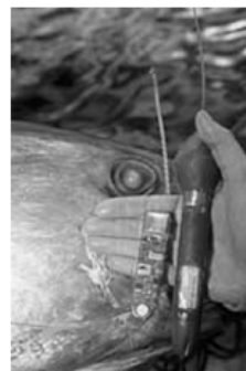
Μια αναδυόμενη ετικέτα αρχειοθέτησης μέσω δορυφόρου (pop-up satellite archival tag — PSAT) και τα εσωτερικά ηλεκτρονικά της.
