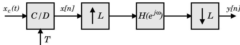
**Λύση:** ‘Σπάμε’ το τρίτο υποσύστημα στην ακολουθία του ιδανικού φίλτρου  $H_{LP}(e^{j\omega})$  (κατωπερατού) και ενός καθυστερητή  $e^{-2j\omega}$ , δηλ.  $H(e^{j\omega}) = H_{LP}(e^{j\omega}) e^{-2j\omega}$ , όπου:
