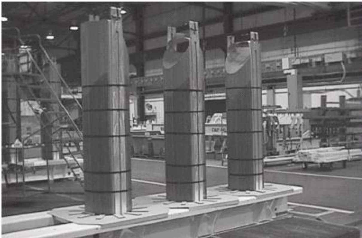
Στελέχη τριφασικού ΜΣ υψηλής τάσης τύπου Ε
