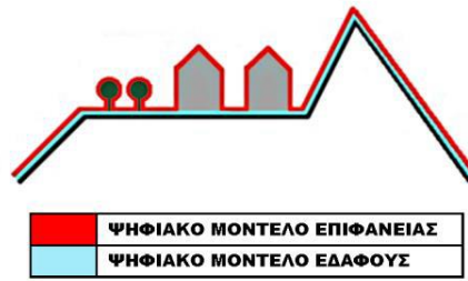
Εικόνα 2.2: Ψηφιακό Μοντέλο Εδάφους (Digital Terrain Model – γαλάζιο χρώμα) και Ψηφιακό Μοντέλο Επιφάνειας (Digital Surface Model- κόκκινο χρώμα). (Χαλκιάς Χ., 2015)
