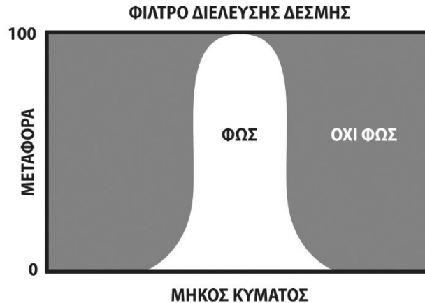
Σχήμα 11.5. Φίλτρο για τη διάσπαση της ακτινοβολίας.
