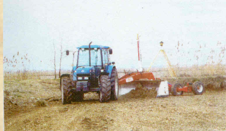
Ισοπέδωση αγρού που θα καλλιεργηθεί με ρύζι. Στο βάθος διακρίνεται, πάνω σε τρίποδο, ο πομπός ακτίνων λέιζερ.
