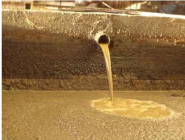
Εικόνα 4: Διαχείριση του κασίγαρου σε δεξαμενές καθίζησης. Πραγματοποιείται μεταφορά της υπερκείμενης λεπτόρρευστης φάσης από την πρώτη δεξαμενή καθίζησης στη δεύτερη όπου και θα προστεθεί ο ασβέστης.
