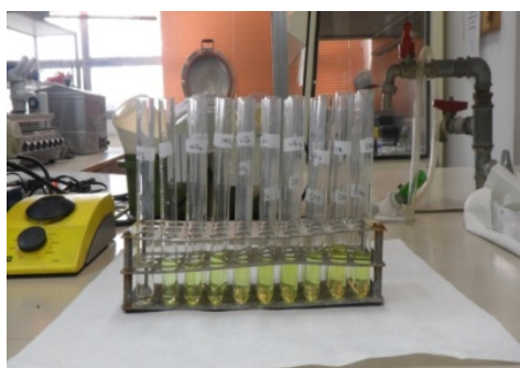
Εικόνα 4. Διαδικασία προσδιορισμού της δραστηρότητας των β-γλυκοσιδασών του εδάφους: (αριστερά) στάδιο διήθησης των εδαφικών διαλυμάτων και (δεξιά) τελικά διηθήματα πριν την φωτομέτρηση
