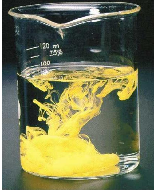
Σχήμα 13. Μη σωστή ανάμειξη όπου η συγκέντρωση της ουσίας μπορεί να κυμαίνεται στο διάλυμα από \approx 0\% στα επιφανειακά στρώματα του διαλύματος, έως 100\% στο βυθό του διαλύματος.
