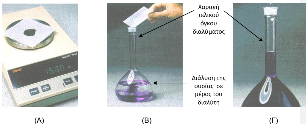
Σχήμα 12. (Α) Σωστή ζύγιση της ουσίας, (Β) Διάλυση της ουσίας σε μέρος του διαλύτη, (Γ) Πλήρωση του διαλύματος με τον διαλύτη μέχρι τελικού όγκου.
