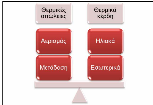
Σχήμα 3.1.2. Ενδεικτικό σχήμα με το οποίο αποδίδεται το ενεργειακό ισοζύγιο των θερμικών απωλειών και των θερμικών κερδών του κτηριακού κελύφους.
