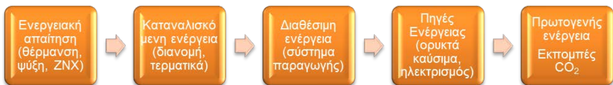
Σχήμα 3.1.1. Σχηματική απεικόνιση των υπολογισμών για θέρμανση / ψύξη και Ζ.Ν.Χ. σε ένα κτήριο.
