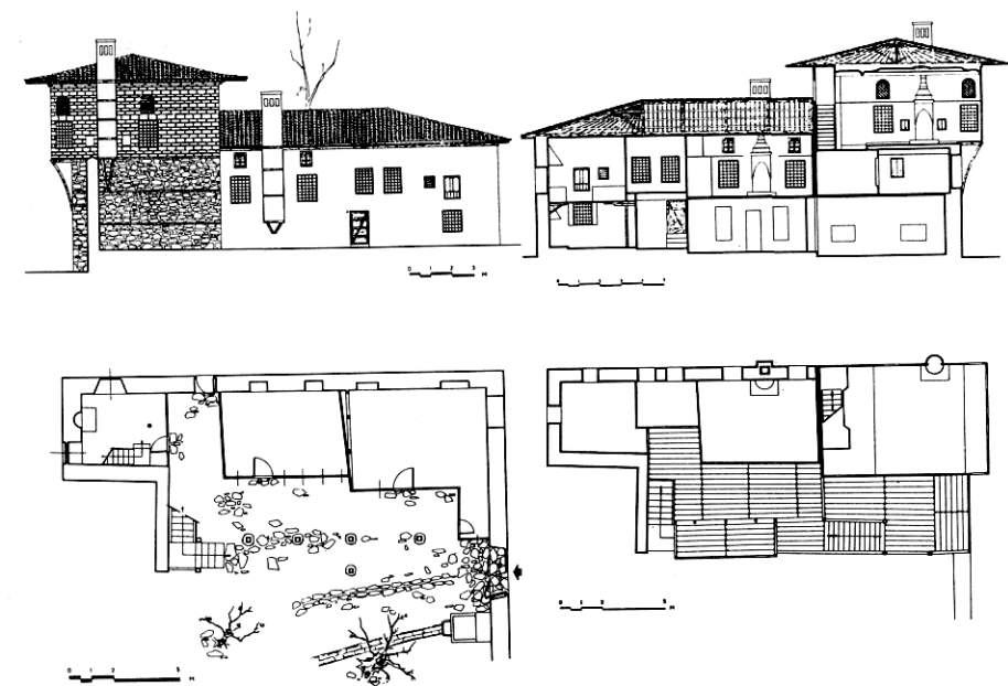
Ἀρχοντικό τῆς Τουρκοκρατίας. Τοῦ σιορ-Μανωλάκη στήν Βέροια. Ὦση, τομή καί κατόψεις σέ δύο στάθμες (Ν. Μουτσόπουλος).
