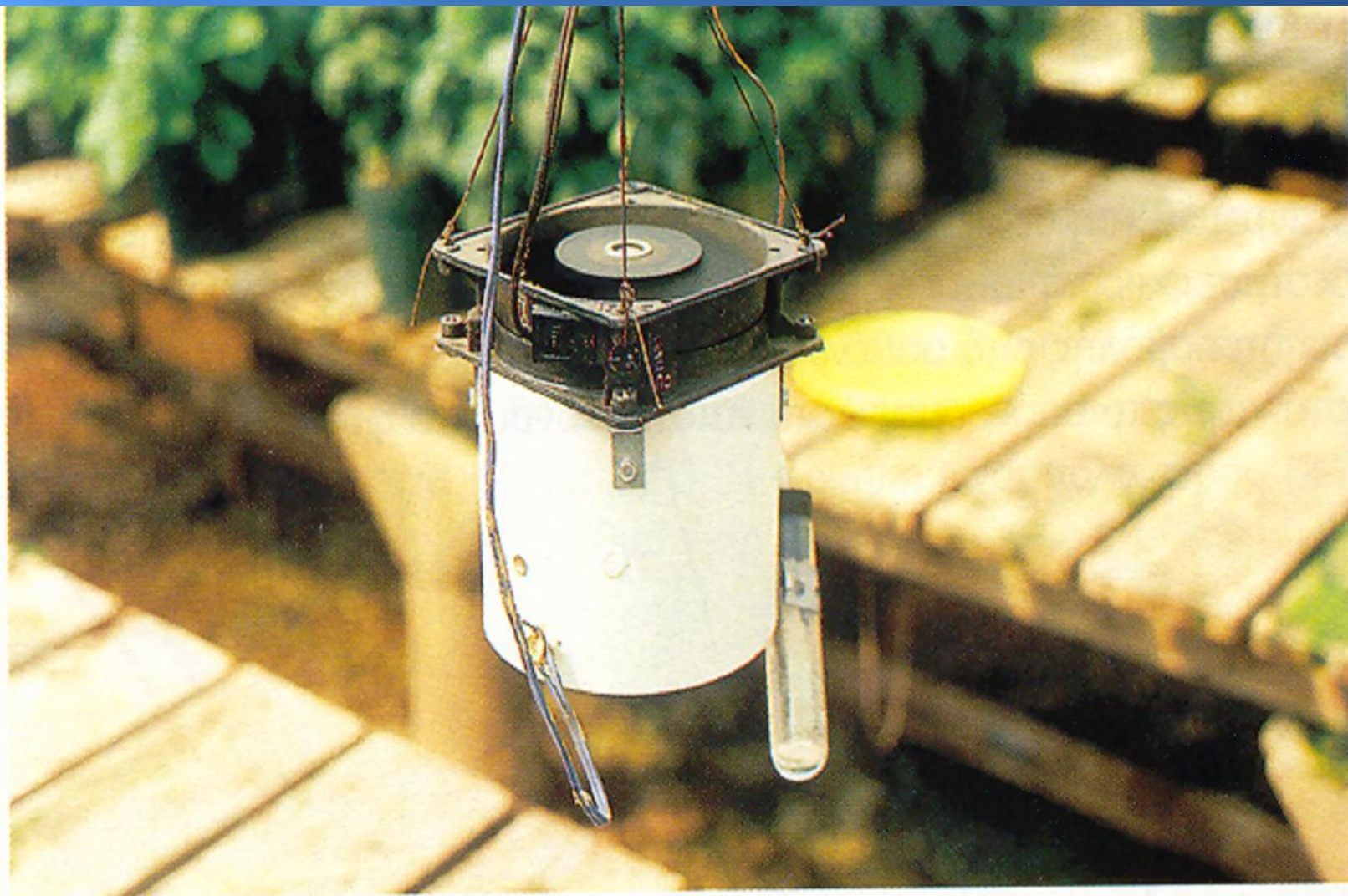
Εικ. 1.81: Όργανα (sensors) για τη διακρίβωση και καταγραφή των συνθηκών του περιβάλλοντος (θερμοκρασίας, υγρασίας) στο θερμοκήπιο, τοποθετημένα σε ειδικά αεριζόμενες συσκευές (Aspirated screens).
