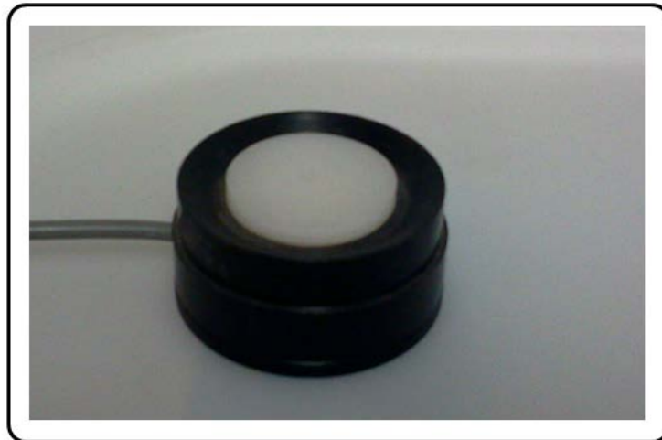
Σχήμα 2.3: Αισθητήρας φωτισμού (με διόρθωση συνημιτόνου)
