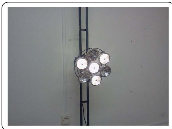
Σχήμα 5.12: Οι πηγές φωτισμού που χρησιμοποιούνται πρέπει να έχουν στενή δέσμη. Αν υπάρχει δαθεσιμότητα χώρου τότε μπορεί να χρησιμοποιηθεί και φακός Fresnel για τον επιπλέον παραλληλισμό της φωτεινής δέσμης.
