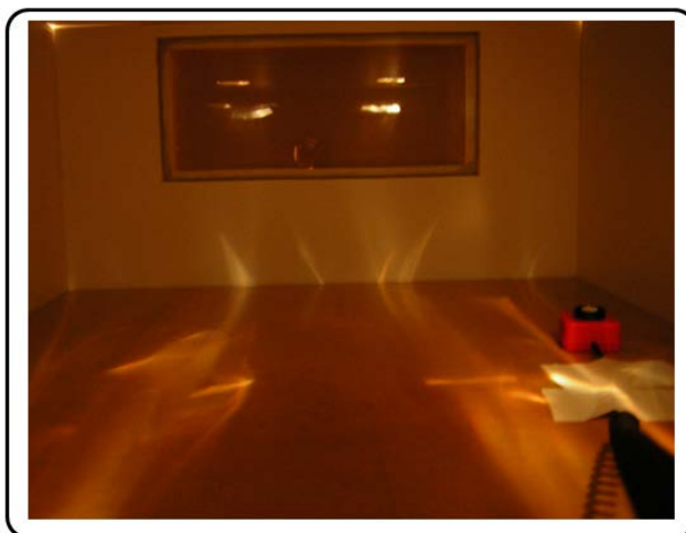
Σχήμα 7.100: Αν δεν χρησιμοποιηθεί διαχύτης στην έξοδο του συστήματος μεταφοράς τότε υπάρχει περίπτωση τα ηλιακά ίχνη που σχηματίζονται (μετα τις ανακλασεις) να δημιουργούν ενοχλητικά μοτίβα.
