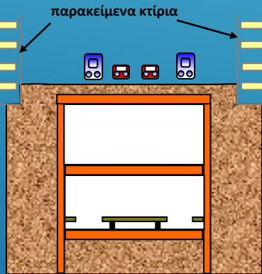
Κατασκευή δαπέδου σήραγγας ή σταθμού με διαδρόμους διαφυγής
