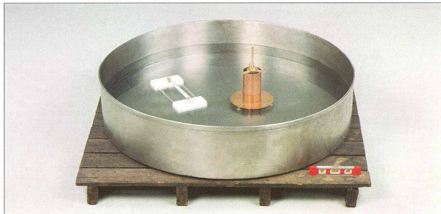
Εικ. Α.1. Εξατμισόμετρο τύπου Α με μικρόμετρο για τη μέτρηση της εξάτμισης
