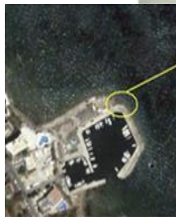
Κυματοθραύστης με αγωγό ανανέωσης στο Μάτι.
