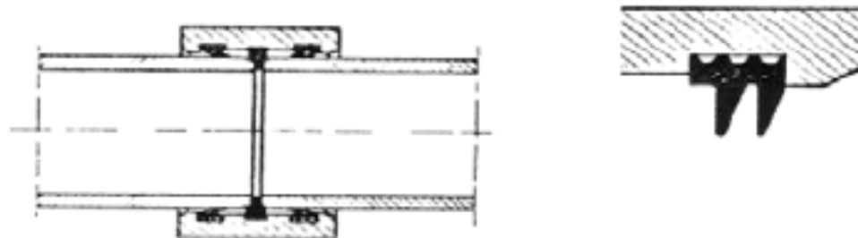
Σχήμα 7. Σύνδεση αμιαντοτσιμεντοσωλήνων με σύνδεσμο REKA.
