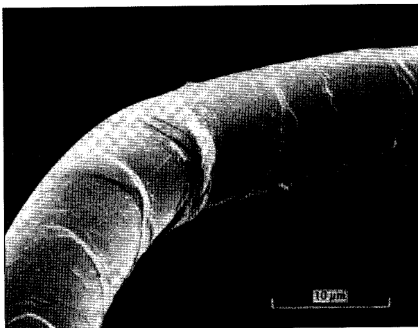
Εικόνα 3.17 Μικροφωτογραφία ίνας Kevlar 49 όπου φαίνονται οι πτυχώσεις στην θλιβόμενη πλευρά
