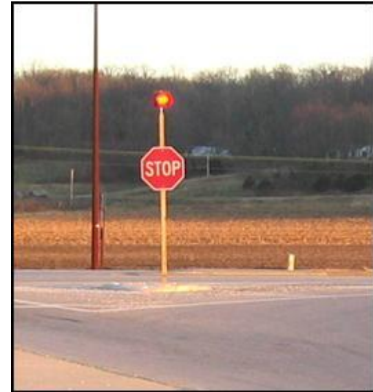
Εικόνα 7.11: Αναλάμπων σηματοδότης σε πινακίδα STOP
