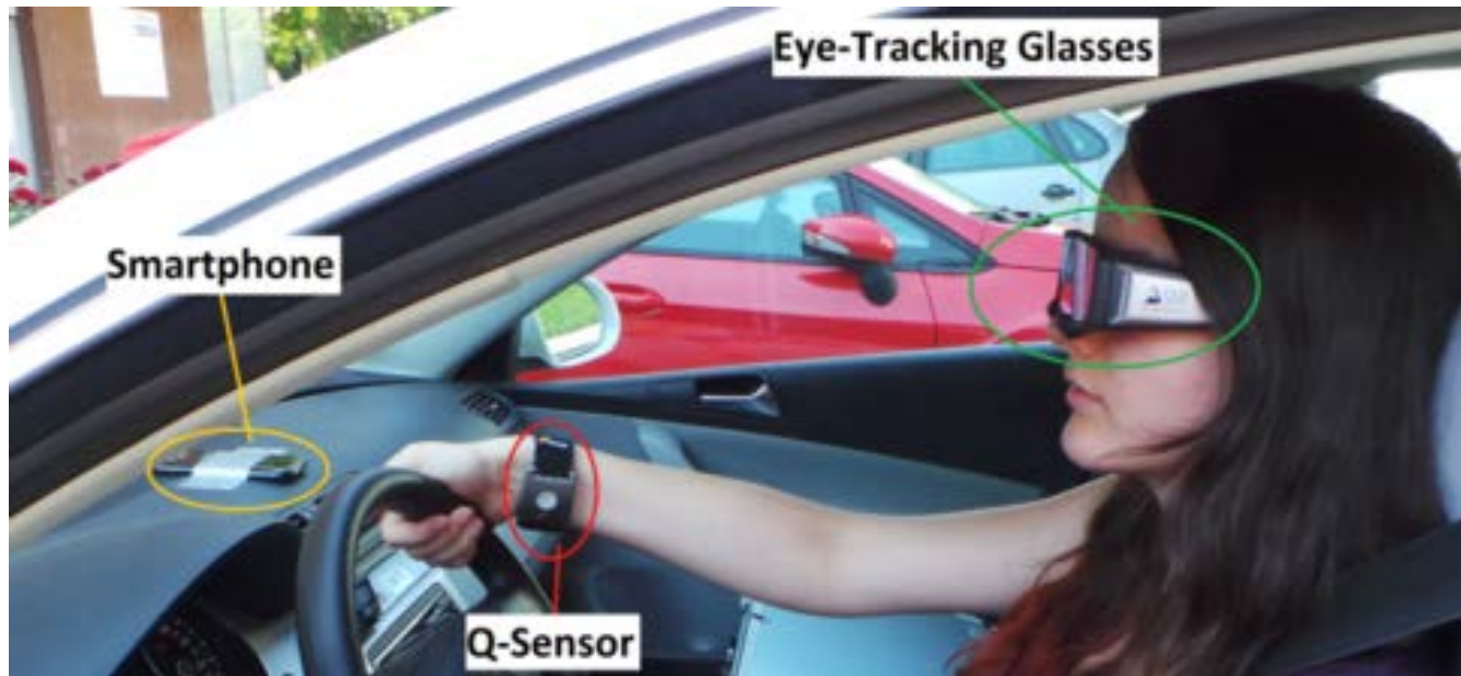
Εικόνα 3.1: Σύστημα παρακολούθησης των ματιών οδηγού
