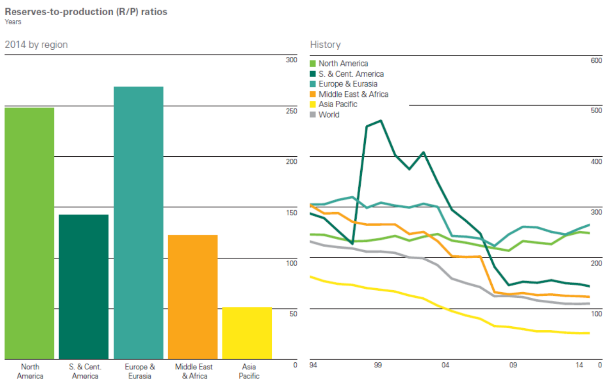
Σχήμα 3.8. Λόγοι αποθεμάτων γαιάνθρακα ανά περιοχή (αριστερά) και λόγοι αποθεμάτων (δεξιά) προς το ρυθμό παραγωγής του. Με το λόγο αυτόν εκτιμάται ο χρόνος εξάντλησης αυτού του καυσίμου στα 268 χρόνια με την προϋπόθεση του σταθερού ρυθμού παραγωγής (BP Statistical Review 2015).
