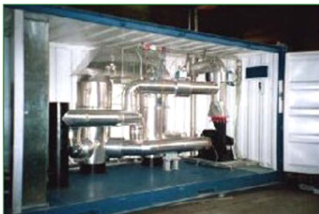
Κινητός καταλυτικός μετακαυστήρας VOC.
