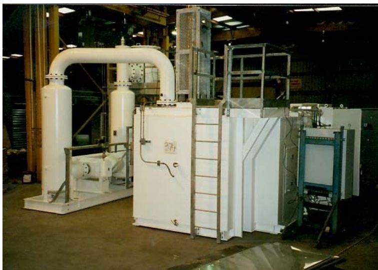
Καταλυτικός μετακαυστήρας VOC.
