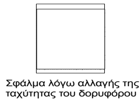
Σχήμα 4.4 Γεωμετρικά σφάλματα λόγω περιστροφής της γης και αλλαγής ταχύτητας του δορυφόρου.
