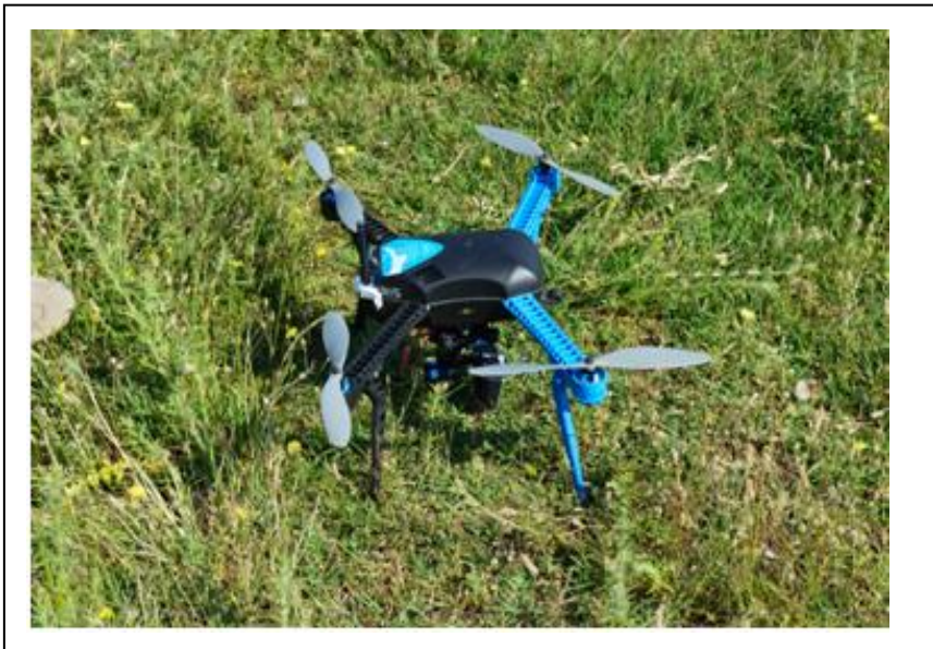
Εικόνα 13.12 Υπερ-ελαφρύ Τετρακόπτερο – UAV με προσαρμοσμένη φωτομηχανή.
