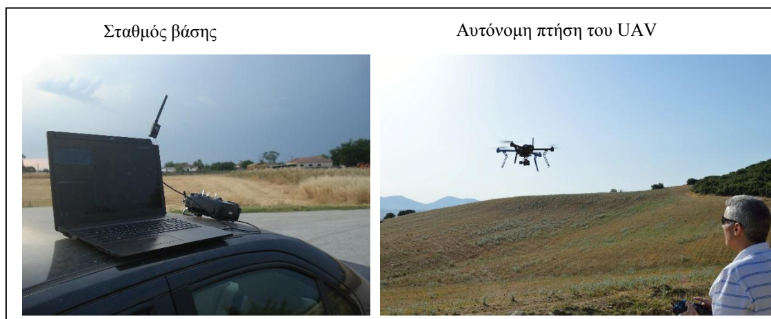
Εικόνα 13.14 Σταθμός βάσης και UAV για αυτόνομη αεροφωτογράφιση.
