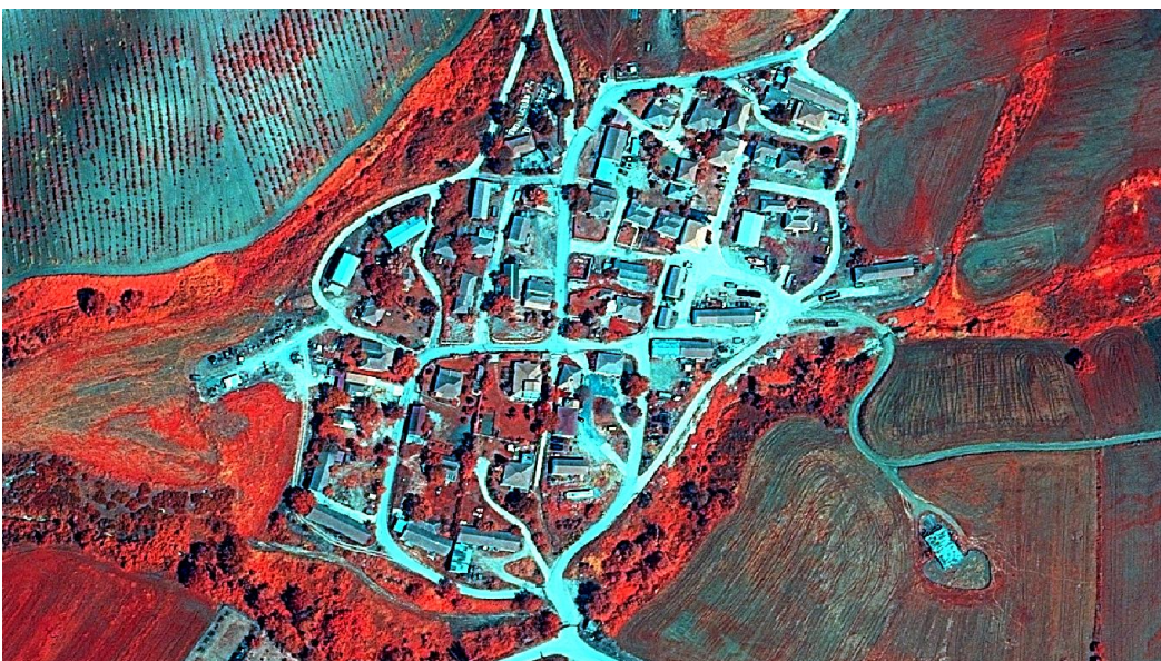
Εικόνα 3.20 Χωριό Αγία Τριάδα, Φαρσάλων Χρωματική σύνθεση των φασματικών καναλιών 1,2,4 σε B,G,R του δορυφόρου Geoeye της 05/04/2015, PIXEL SIZE 0,5x0,5.
