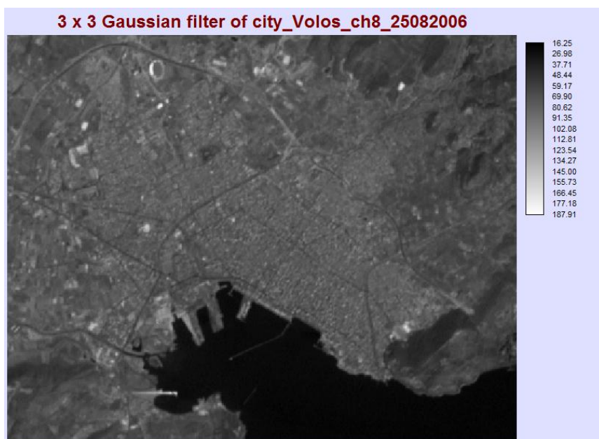
Εικόνα 8.6 Η εικόνα του πολεοδομικού ιστού του Βόλου στο παγχρωματικό κανάλι μετά την εφαρμογή του φίλτρου του Gauss διαστάσεων 3 X 3 με ημ/νία καταγραφής 25-08-2006.
