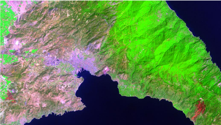
Εικόνα 3.12 Περιοχή της Θεσσαλίας με τον Βόλο στο κέντρο και το δάσος του Πηλίου στα ανατολικά. Ψευδοχρωματική σύνθεση των φασματικών καναλιών 1,4 και 7 σε B,G,R δορυφορικής εικόνας Landsat 7 της 28/04/2000, PIXEL SIZE 30x30μ.
