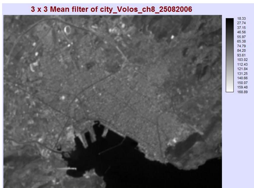
Εικόνα 8.2 Η εικόνα του πολεοδομικού ιστού του Βόλου στο παγχρωματικό κανάλι μετά την εφαρμογή του φίλτρου της μέσης τιμής διαστάσεων 3 X 3 με ημ/νία καταγραφής 25-08-2006.
