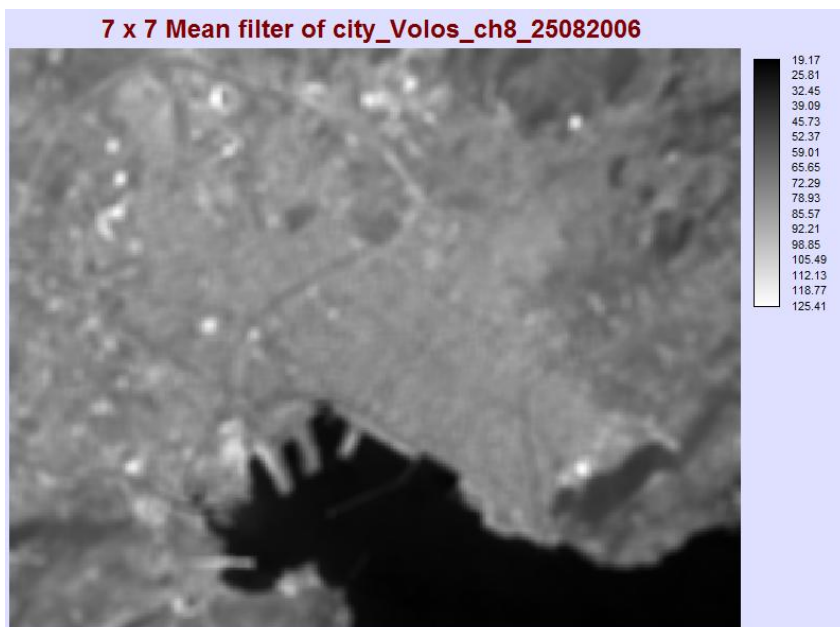
Εικόνα 8.3 Η εικόνα του πολεοδομικού ιστού του Βόλου στο παγχρωματικό κανάλι μετά την εφαρμογή του φίλτρου της μέσης τιμής διαστάσεων 7 X 7 με ημ/νία καταγραφής 25-08-2006.
