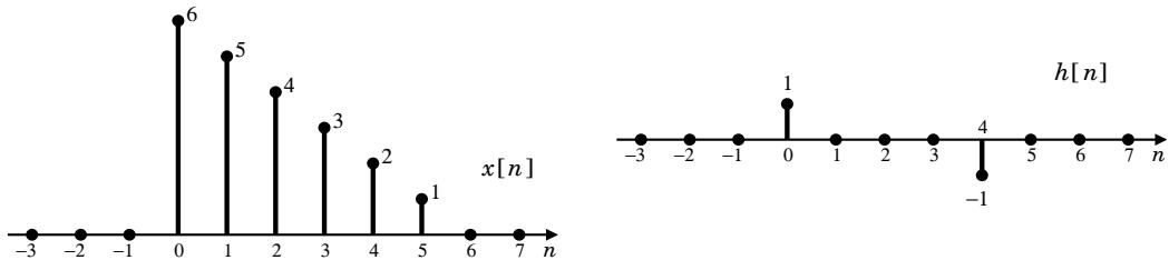
**Άσκηση 6:** Υπολογίστε τη γραμμική συνέλιξη  $y[n] = x[n] * h[n]$  των σημάτων του παρακάτω σχήματος ακολουθώντας τη μεθοδολογία του αλγόριθμου επικάλυψης-πρόσθεσης (overlap-add method). Για το σκοπό αυτό, θεωρήστε διαδοχικές υποακολουθίες του σήματος  $x[n]$ , μήκους  $L = 10$  κάθε φορά. Εξηγείστε αναλυτικά.
