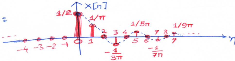
• Υποψιαζόμαστε ότι πρόκειται για σήμα ενέργειας, καθώς το  $x[n]$  είναι ένα κομμάτι του sinc function. Για το τελευταίο μπορούμε να χρησιμοποιήσουμε το θεώρημα Parseval και τον μετασχηματισμό DTFT.
